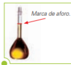
Matraz volumétrico conteniendo 100 mL de un líquido.
